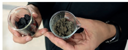
Puhdistamolietteen mädätettä (oikealla) ja siitä tuotettua/pyrolysoitua lietehiiltä (vasemmalla).
