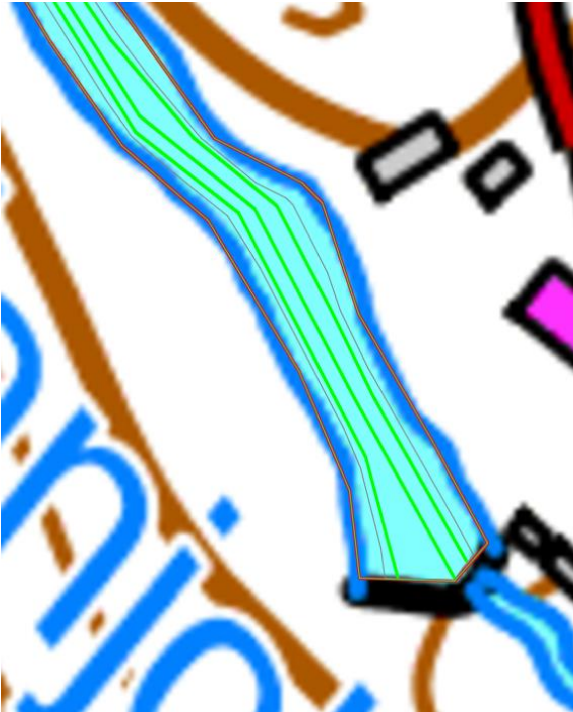
Kuva 4. Pohjan taiteviivoja Katiskosken padon yläpuoleisella jokijaksolla (vihreät viivat), joilla luotiin jokijaksosta yläallas. Taustakartta Maanmittauslaitos 11/2021.
